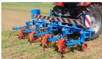
Figure 3. Herse étrille (en haut à gauche), houe rotative double (en haut à droite) et bineuse (en bas)
